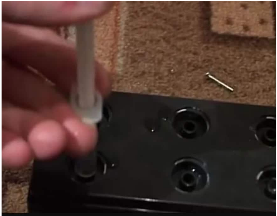
Рисунок 9 - Возьмите шприц и наберите 1–2 кубика дистиллированной воды, влейте воду в каждую банку
