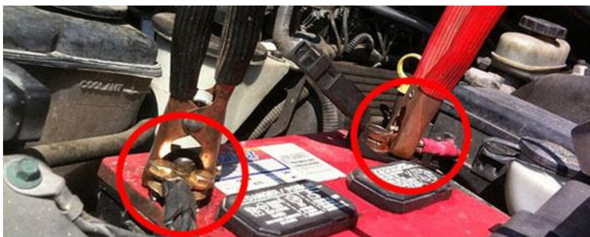
Рисунок 3 Зарядка АКБ внешним источником
